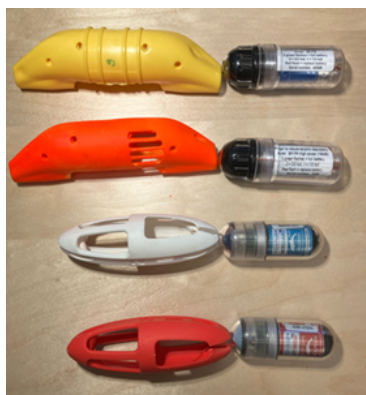
Figur 2.1: Pingers som ingår i studien (från topp till botten): Gul Fishtek, Röd Fishtek, Vit Netguard, Röd Netshield. Till höger syns själva pingern och till vänster dess plastskydd.
